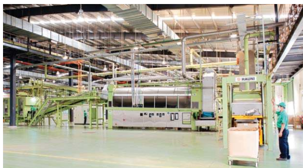
Dây chuyền chế biến sợi công suất 6 tấn/giờ
